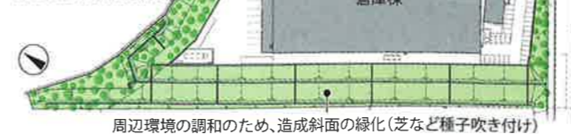
周辺環境の調和のため、造成斜面の緑化（芝など種子吹き付け）
